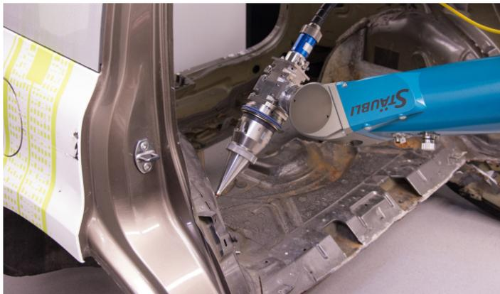
*Système laser de micro-usinage*
