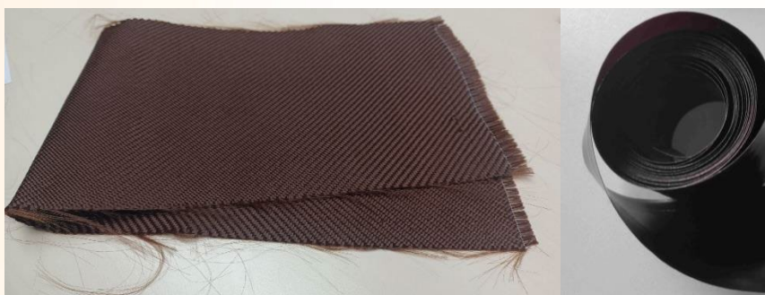
Gauche : échantillon de tissu fabriqué à partir d'un mélange lignine-cellulose. ©DITF Droite : film destiné au laminage sur le textile. ©DITF
